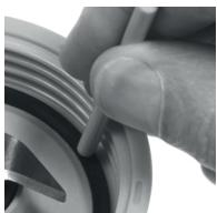
3. Rengør pakning og knivdel omhyggeligt (knivdelen kan vaskes i opvaskemaskine) og sæt derefter pakningen tilbage i hakket på knivdelen. Sørg for at pakningen slutter tæt i bunden af knivdelen ved at trykke den ned med plastikpindens stumpe ende. Hvis pakningen ikke sættes korrekt på knivdelen, er der risiko for lækage.
