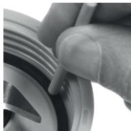
3. Rengör packning och knivenhet noga (knivenheten kan diskas i diskmaskin) och sätt därefter tillbaka packningen i skåran på knivenheten. **Var noga med att se till att packningen sluter tätt i botten av knivenheten genom att trycka ner den med hjälp av plaststickans trubbiga ände.** Om packningen inte sätts tillbaka korrekt finns risk för läckage.
