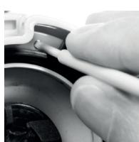
1. Skru løs knivenheten fra flasken. (Merk, at knivene er veldig skarpe). Snu knivenheten på hodet og trykk inn plastpinnen i det lille hullet på undersiden på knivenheten.
