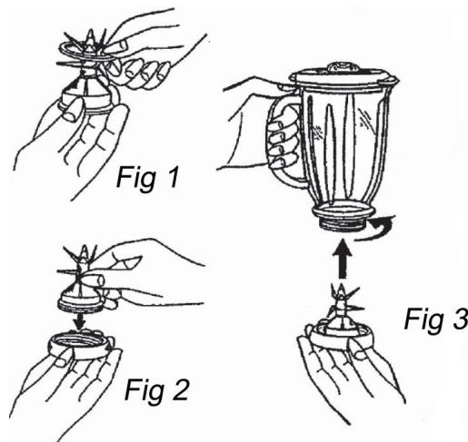
Tehosekoittimen moottori pyörittää terää suurella nopeudella, jolla varmistetaan perusteellinen sekoittuminen. Tästä syystä on tärkeää, että ennen laitteen käynnistämistä se asetetaan aina tasaiselle ja kuivalle alustalle. Samoin on varmistuttava, että kulho on oikealla tavalla kiinnitetty moottoriosaan, koska muussa tapauksessa laite ei käynnisty.
